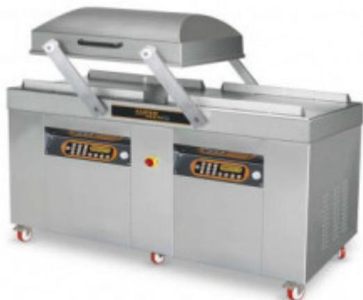
Cette **Machine Sous-Vide à Cloche SUPERMEGA avec Pompe Busch** est idéale pour les professionnels de la restauration. Adaptée à une utilisation industrielle, elle dispose d'une puissance allant de 100 à 120 m<sup>3</sup>/h. Elle comprend 4 barres de soudure de 800 mm et 2 cloches pour doubler son rendement.
