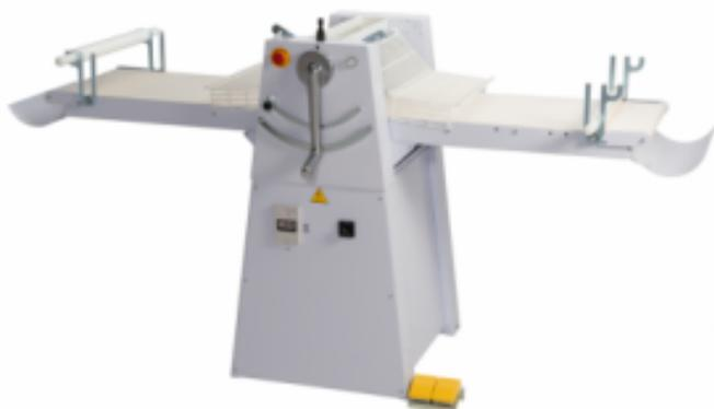
Ce Laminoir à Bande Sur Socle - 1 Vitesse est un laminoir à bande au sol avec des tables inclinables, une largeur de travail de 500 mm et une longueur de bande de 1000 mm. Avec des racleurs amovibles et une vitesse d'alimentation à l'entrée de la bande de 12,2 m/min et une vitesse d'alimentation à la sortie de 22,5 m/min. Dimensions : L 2380 x P 890 x H 1265 mm.
