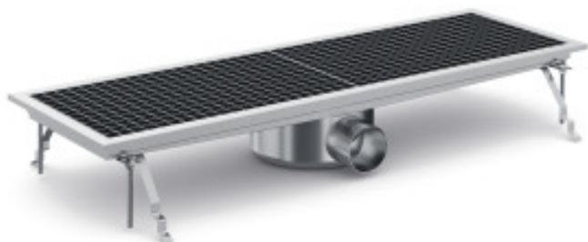
Idéal pour les professionnels de la restauration, ce **Caniveau de Sol** dispose d'une connexion de drainage de 74 mm. Il est réalisé en acier inoxydable AISI 304, un matériau à la fois robuste et durable. Sa longueur est de 927 mm, sa profondeur est de 300 mm et de sa hauteur est de 140 mm.
