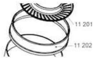
Pièce détachée : cercle aluminium 11202 pour Presse Agrume SS 11C. Fabrication française.
